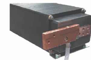
Силовой трансформатор с обмоткой, залитой специальным компаундом, с шихтованным сердечником и системой водяного охлаждения обеспечивает работу с высокой продолжительностью включения. Машина не имеет проблем даже при многосменной работе.
